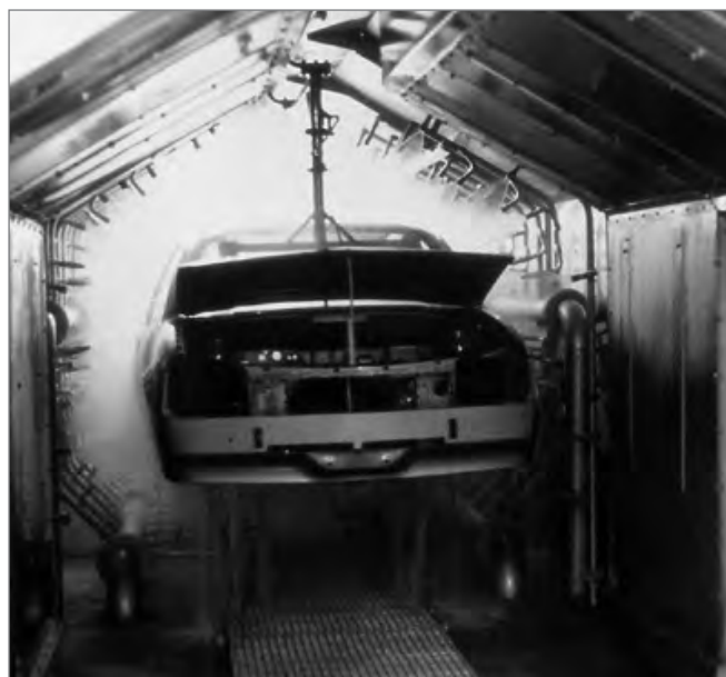
Установка для обезжиривания и фосфатирования
